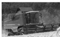
Combină FENDT Serie C-motor 6 cil. AGCO Sisu Power, 7,6-8,4 L, 270-300 cp, hârțică 8,6 sau 9
