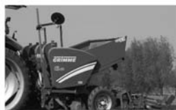
Mașină de plantat carotă în 4 rânduri GRIMME - GL 428, foarte fiabilă, copie a modelului GL 32 ECO (în 2 rânduri), montată pe un cadru alungit
