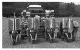
Mașină de plantat FERRARI F-MAX – 1-6 rânduri, productivitate un element 1500 plante/oră, înălțimea plantelor max 25 cm, putere necesară 35-70 cp
