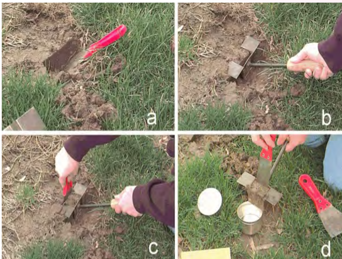
Fig. 2.20. Prelevarea probelor pentru evaluarea porozității solului
