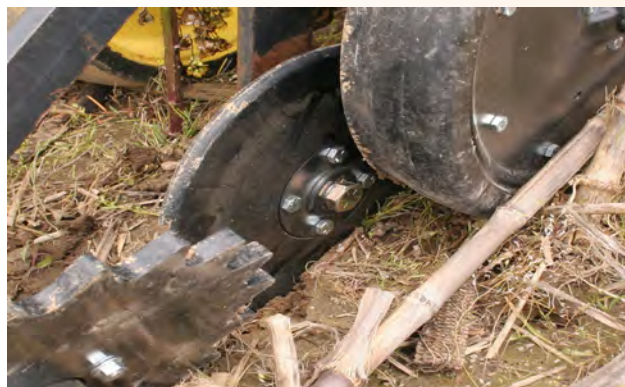
Fig. 3.13. Componentele unui aparat de semănat direct. În centru – dispozitiv de încorporare a semințelor
